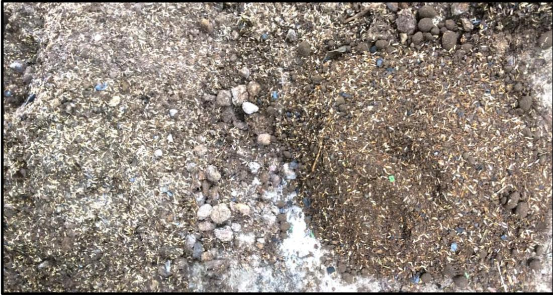
**Figura 5.** comparación de resultados luego de realizar volteo de manera manual con pala (Montículo izquierda) y con uno de los modelos desarrollados (Montículo derecha)
