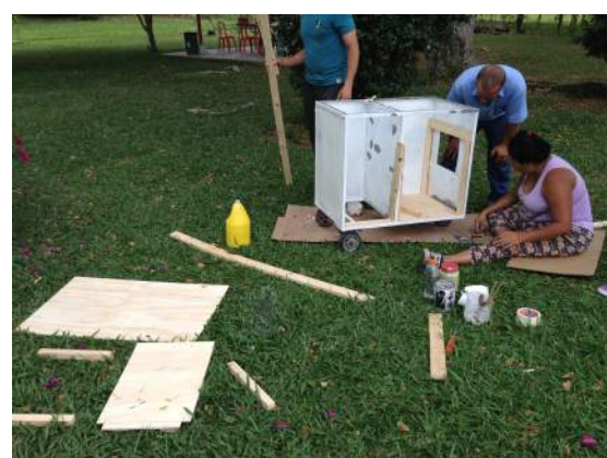
Limpieza, lijado, aplicación de anticorrosivo, pintura y ensamblaje del ayudante de cocina.
