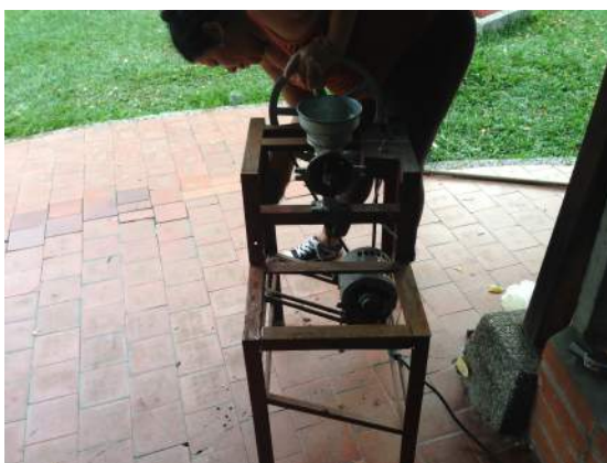
Lijado y cortado de la estructura de soporte para la trituradora mecánica Moli.
