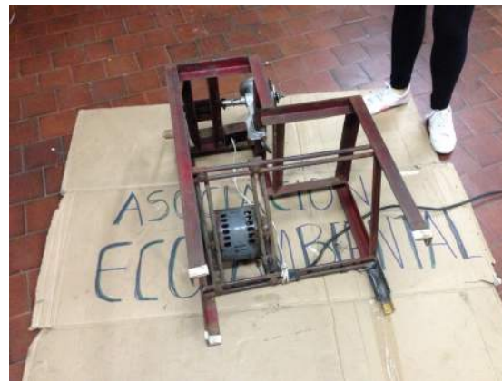
Lijado y cortado de la estructura de soporte para la trituradora mecánica Moli.
