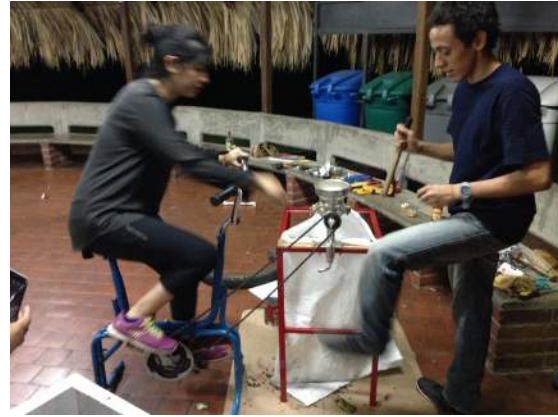
Preparación de estructura de soporte para la trituradora y de la bicicleta para accionar el prototipo.
