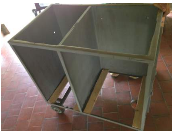
Limpieza, lijado, aplicación de anticorrosivo, pintura y ensamblaje del ayudante de cocina.
