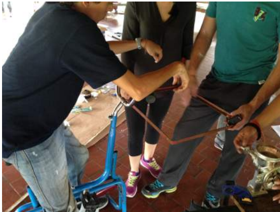
Preparación de estructura de soporte para la trituradora y de la bicicleta para accionar el prototipo.
