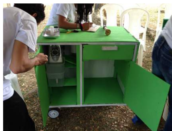
(Izq) Colocación de puertas, gaveta, simulación de motor, y recipiente para aceite. (Der)presentación del prototipo terminado en Parque del Ingenio, Cali.
